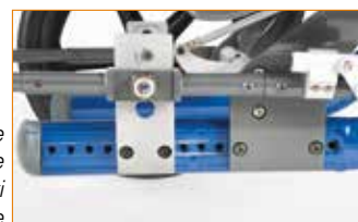
Posizione dell'asse ruote posteriori regolabile
