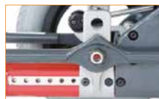
Posizione dell'asse ruote posteriori regolabile
